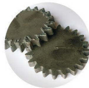
Slag removal Schlackenentfernung Slakverwijdering
