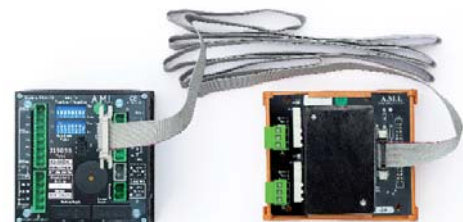
Carte M0901 «relais de report» type DIN connectée au panneau J1905S
