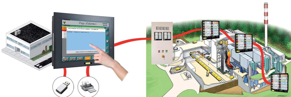
Bus RS485 / 1 km / equipado con 64 módulos como máximo
