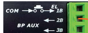
External «LEDs test» connection and «AUX» button on front
