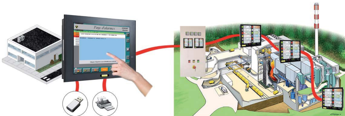
Bus RS485 / 1 km / mit höchstens 64 Modulen ausgestattet
