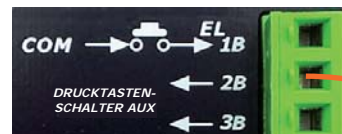
Außenseitiger Anschluss „Test-LEDs“ (EL) und Taste „AUX“ an der Frontplatte
