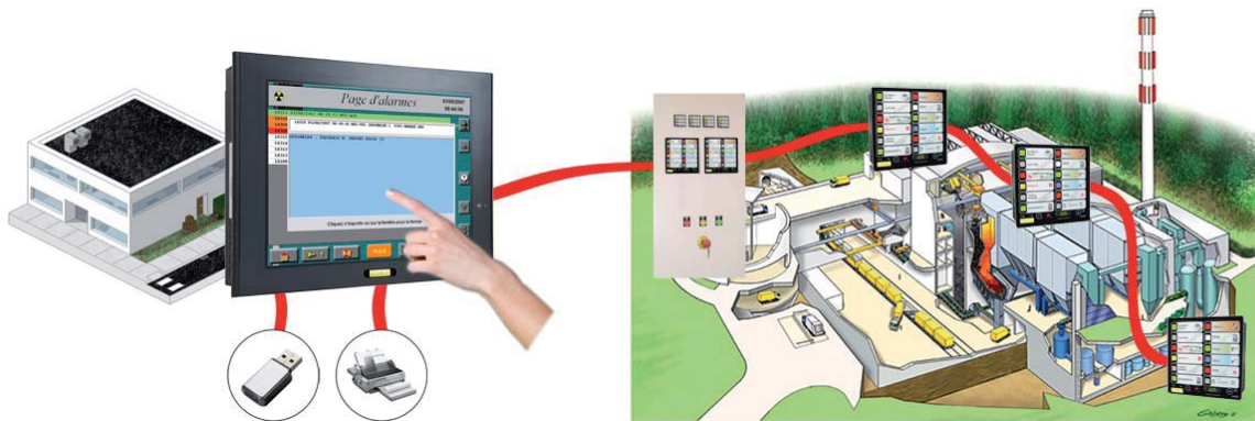
Bus RS485 / 1 km / mit höchstens 64 Modulen ausgestattet
