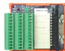
DIN-Platine M0901 „Übertragungsrelais“, angeschlossen an Tafel J1905S
